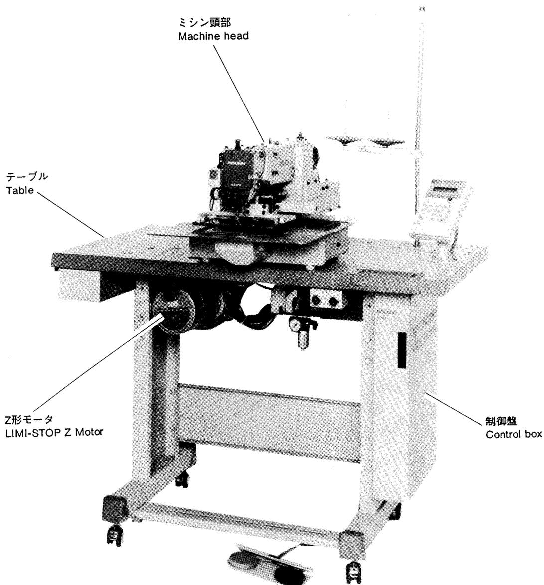
注1：モータ部分は三菱リミストップZクラッチ：モータの部品カタログ(P-007)を参照ください。
